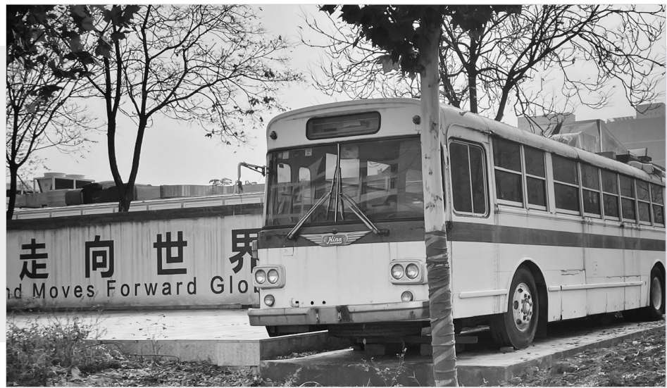
图为停驻在中国康复研究中心西区一隅的残疾人专用车。它是我国最早一批从国外引进的残疾人专用车辆，内可固定装载8辆残疾人轮椅，升降机可帮助轮椅上的残疾人顺利上下车。 本报记者张丹摄
